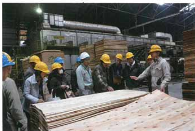
桂剥きされた薄板 この後、積層→圧着→乾燥→切断整形される
