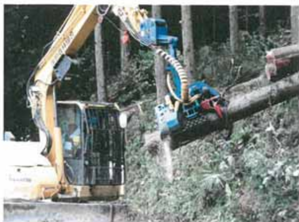
ハーベスタによる造材作業を見学
