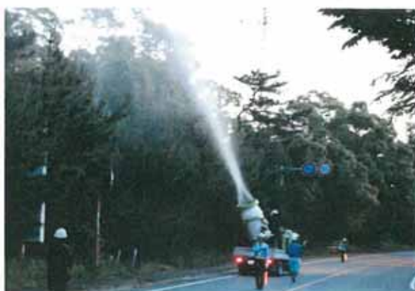
スパウターによる地上散布の状況
