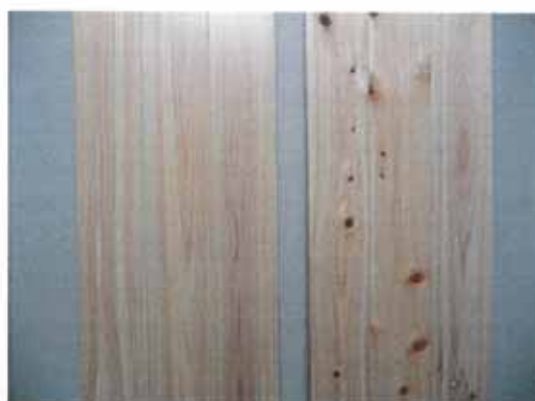
完成したS品(左)とA品(右)フローリング
