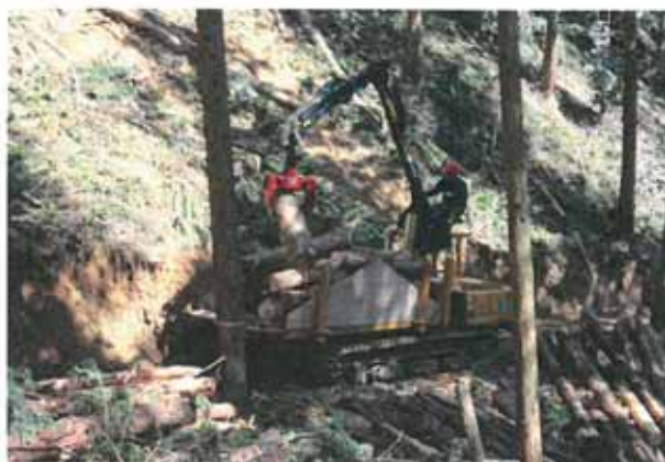
コンパネ簡易枠設置車両による収集作業
